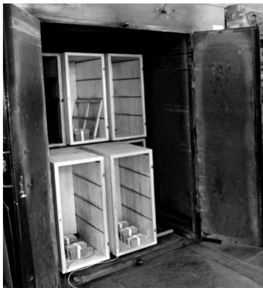
Esperimento sulla disinfezione di materiale apicolo in un forno industriale presso un apicoltore nella regione di Glarona: arnia svizzera con rilevazione della temperatura nel forno.
