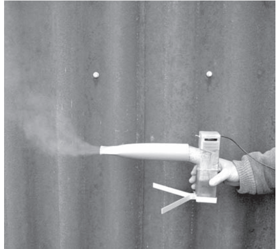
Figura 2 - Flusso di nebulizzazione del primo prototipo a ultrasuoni impiegato nei test del 2005.
