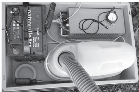
Figura 4 - Dispositivo a ultrasuoni adattato con batteria per auto e trasformatore per il trattamento con acido ossalico nei test 2006 e 2008.
